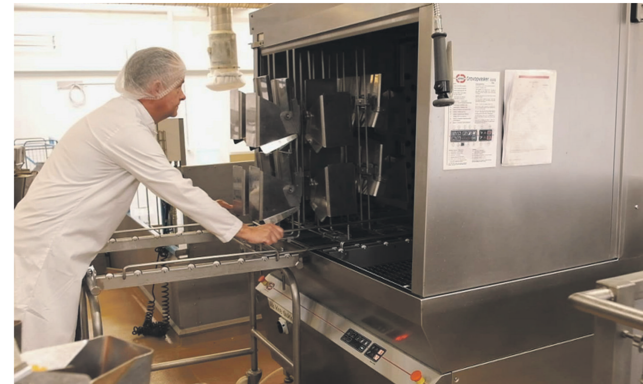
Die Maschinen von JEROS verwenden einen vor und zurück fahrenden Spülrhythmus, an dem Turbinen die Teile zunächst bei 52 Grad waschen und anschließend mit 85 Grad heißem Wasser spülen. So ist sichergestellt, dass sich keine Listerien, Salmonellen oder andere Bakterien auf den gespülten Teilen befinden, die anschließend mit Produkten in der Produktion in Berührung kommen und diese kontaminieren.
